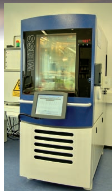
Bei Klimaprüfungen können Temperaturwerte im Taupunktbereich von +4°C bis -3°C auf Grund der Eisbildung am Entfeuchtungskühler max. 70 Stunden gehalten werden. Die minimalste Klimaeinstellung liegt bei 10°C bei 40% relativer Feuchte.
